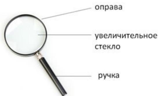
**Рис. 1.** Строение ручной лупы
