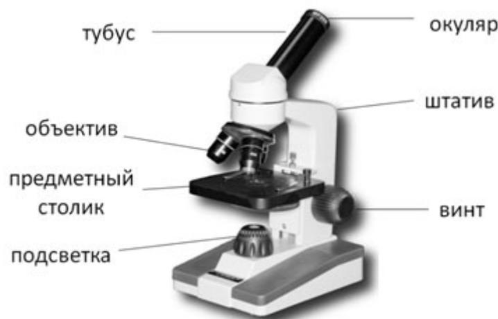
**Рис. 2.** Строение микроскопа
